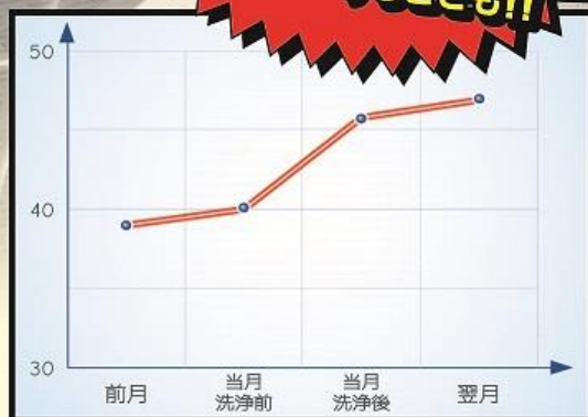
▲洗浄前後の発電効率 (発電量÷日射量にて発電効率数値を算出)
